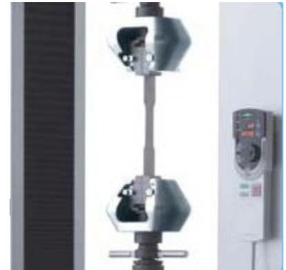
図9 試験片の取り付け
