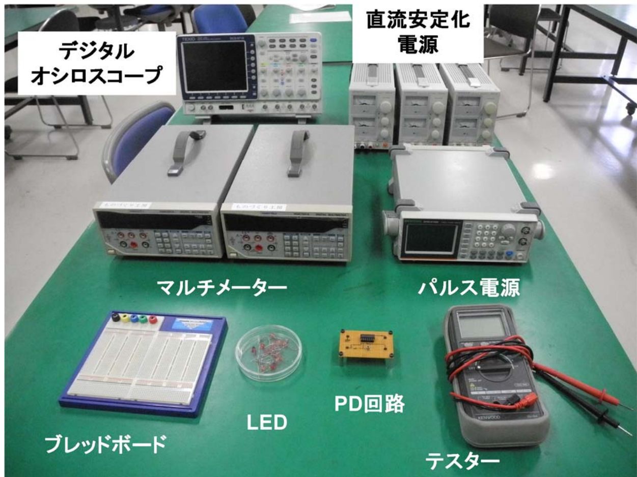
図6 光センサーの実験で用いる各種の機器と装置
